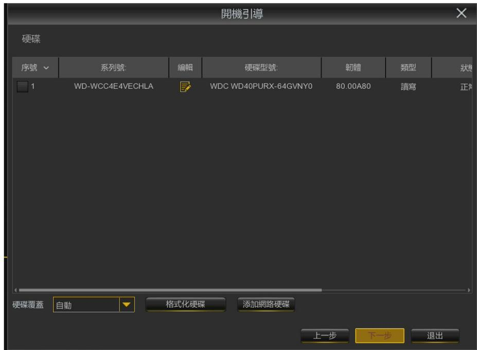
1. 當硬碟首次安裝在主機時，需要對硬碟進行格式化。選擇硬碟，然後按一下“格式化硬碟”功能，對硬碟進行格式化。
